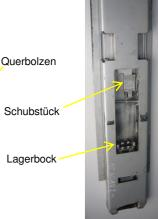
2. Einbau der neue Handhebelmechanik (1)
