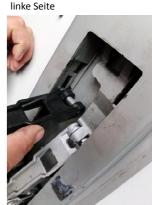
Federdruck in die entsprechende Stellung gebracht. Anschließend werden die Handhebel in Richtung Lagerbock geschwenkt. Ein neuer Querbolzen wird nun wieder in die Runge gedrückt und dabei die Handhebel mit aufgefädelt. (Bolzen Ø8x75 (2) bei Rungen bis 500mm, Ø8x110 (3) bei den 600 – 1000 mm langen Rungen). Der Bolzen ist weit genug in die Runge geschoben worden, wenn der Lagerbock wieder beweglich ist.
