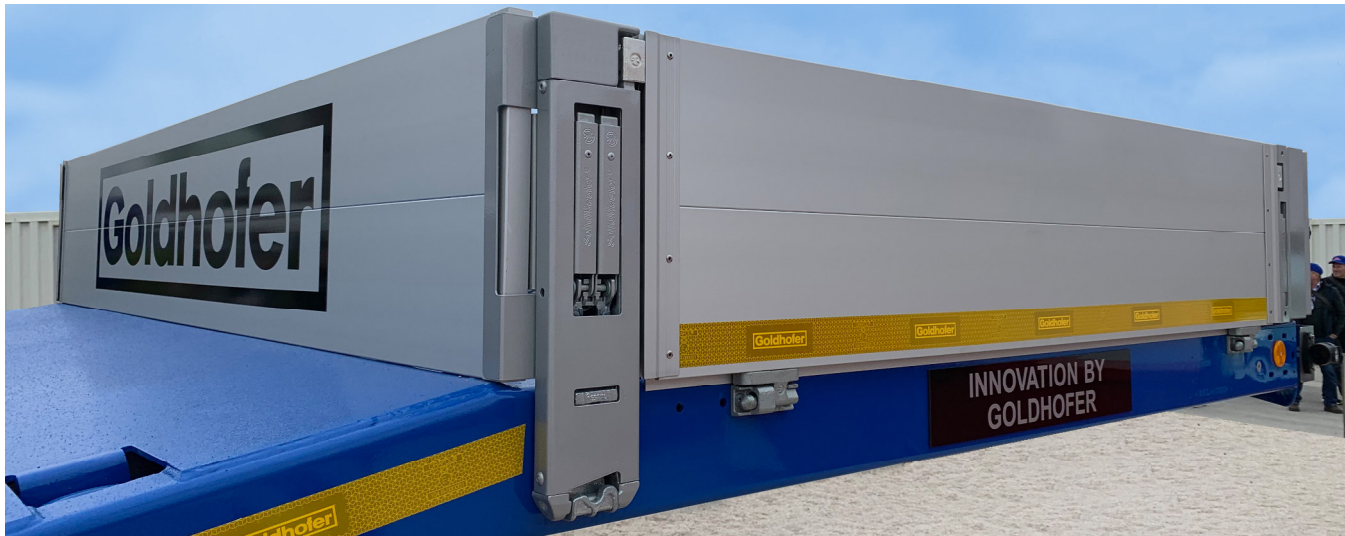
HESTAL SolidMaster 802CHRT Heck, rechts, 90°, offen KTL-und RAL-Pulverbeschichtet
