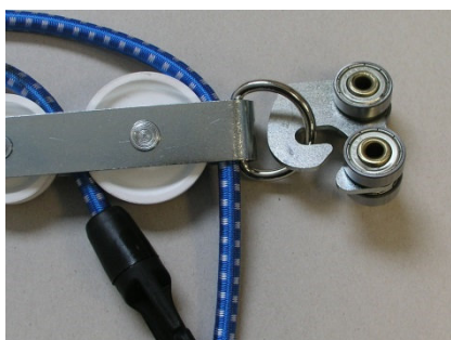
Zweite Seite: BG Umlenkrolle mit D-Ring in Hakenkontur des Laufwagens fügen
