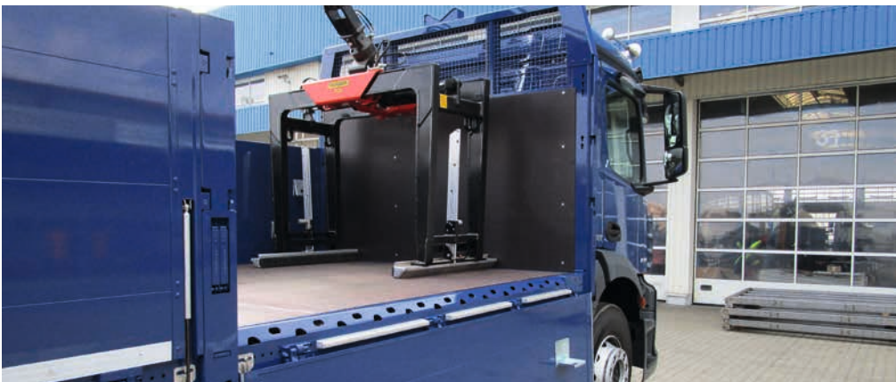
HESTAL SolidMaster 802 Klappungen in 1.000mm mit Doppelverriegelung (KTL- und Pulverbeschichtung)
