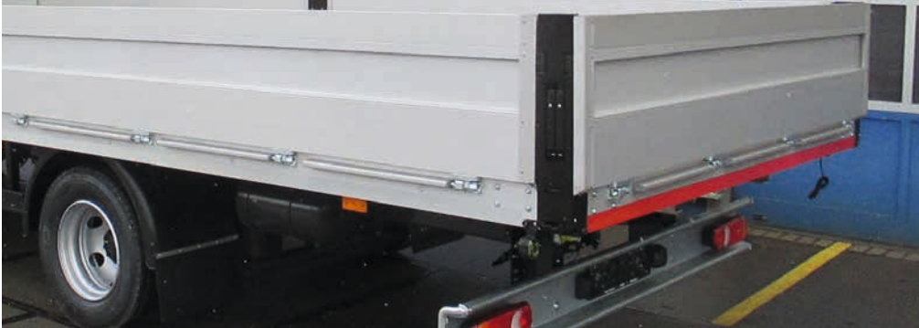
HESTAL SolidMaster 802 Klappungen in 500mm (KTL-Beschichtung)
